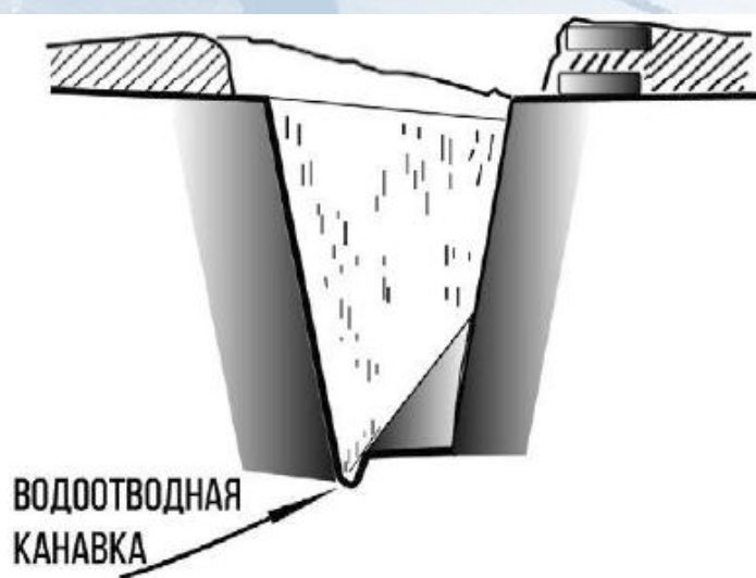
Рис. 2. Водоотводная канавка на дне траншеи
